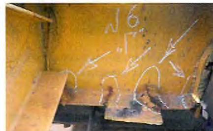
Фото 6. Многочисленные трещины по целому металлу и сварным швам в узлах крепления механизмов передвижения крана
