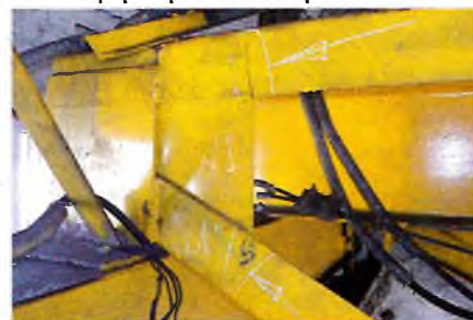
Фото 3 и фото 4. Последствия некачественного ремонта буксовой зоны крана: отрыв «усиливающей» накладки, прожоги и трещины по целому металлу стенки концевой балки
