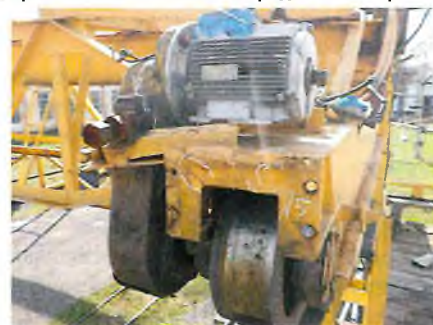
Фото 6. Многочисленные трещины по целому металлу и сварным швам в узлах крепления механизмов передвижения крана
