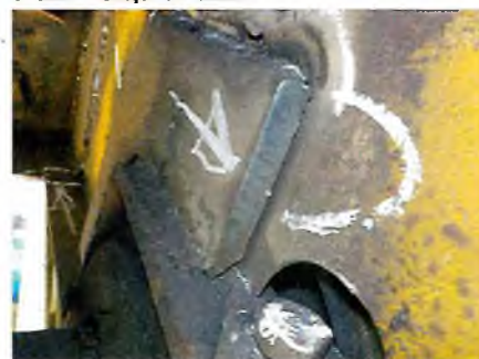
Фото 3 и фото 4. Последствия некачественного ремонта буксовой зоны крана: отрыв «усиливающей» накладки, прожоги и трещины по целому металлу стенки концевой балки
